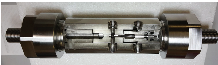
Рис. 2. Устройство для динамического смешивания и гомогенизации в разрезе
